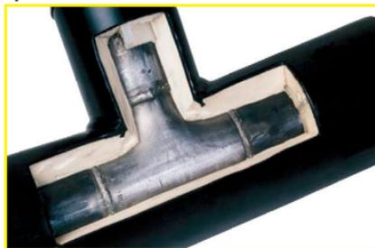
Проход и отвод внутренней трубы с толщиной стенок, соответствующей прямой трубе. Отводы с изгибом на 45° или 90° с размерами, как минимум соответствующими стандарту DIN EN 10220, цельные или с коленом согласно DIN EN 10253-2 и привариваемым патрубком. Начиная от толщины стенок > 3,0 мм с подготовкой под сварные швы благодаря скошенным под 30° краям согласно DIN EN ISO 9692-1. Неизолированные концы стальных труб: 220 мм ± 10 мм.
