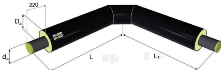
Все колена, независимо от размеров, согнуты из одной трубы в соответствии с стандартом ДИН EN 10220 или в соответствии с DIN EN 10253-2 со сваренным фитингом (патрубком). От толщины стенки > 3,0 мм колена изготавливаются с наклонным срезом 30° с целью подготовки угла для сварки в соответствии с ДИН EN ISO 9692-1.
