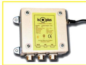
Модемное расширение IPS-Digital-MODEM
