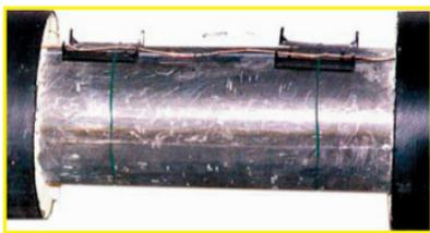
В многослойной трубе с оболочкой два голых медных провода со стандартной площадью поперечного сечения 1,5 мм<sup>2</sup> покрываются пеной на заводе. Для визуального отличия один из проводов подвергается гальваническому лужению. Необходимые соединения проводов внутри муфт трубы-оболочки обеспечиваются при помощи зажимных гильз и дополнительной спайки мягким припоем.
