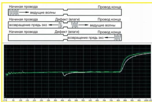
С этой целью **isoplus** предлагает также цифровое контрольное оборудование **IPS-Digital**<sup>®</sup>. Преимуществом этого оборудования является подача импульсов в режиме выборки и хранения данных. Система проводов регулярно опрашивается (выборка), и полученные сигналы сохраняются в промежуточной памяти (хранение).
